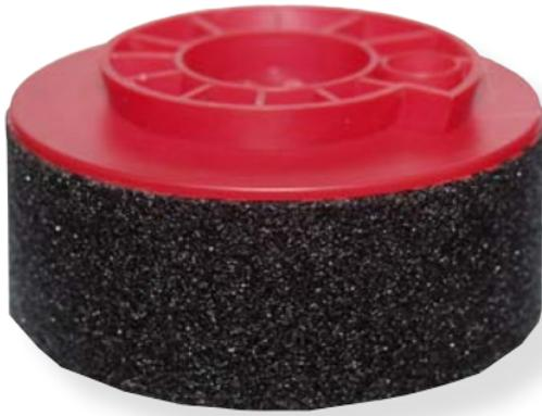
Zum Trockenschliff von Naturstein- und Betonwerksteinen. Zum Einsatz auf Winkelschleifern bis 2000 U/min. Schnellwechseleinrichtung SF-Aufnahme
