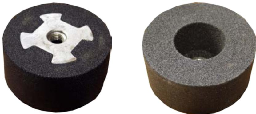
Zum Trockenschliff von Naturstein- und Betonwerksteinen. Zum Einsatz auf Winkelschleifern bis 2000 U/min. Sicherheits - Aluflansch mit M14 - Aufnahme, sehr guter Abtrag bei guter Standzeit
