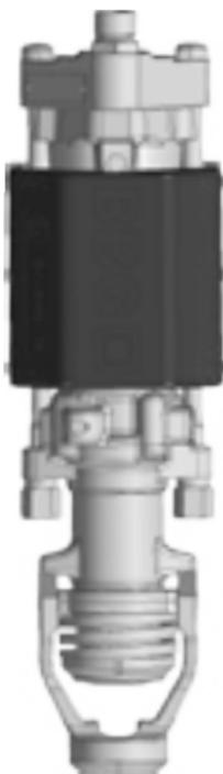
Der leistungsstarke Lafetten-Bohrhammer CR251L für Serienbohrarbeiten mit Bohrlafetten für automatischen Vorschub für Bohrlöcher von 20 bis 90 mm Ø. Für den Dauerbetrieb geeignet. Spülmöglichkeiten mit Luft, Wasser, Emulsion, Stickstoff, mit extremen Druck. Natur- und Kunststein, Beton- und Ziegelmauerwerk, Sprenglochbohrungen, Erkundungsbohrungen, Bergsicherung, Tunnelbau, Stollensicherung usw..
