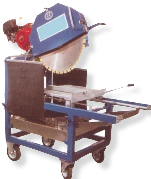
Die besonders leichte Tischsäge GDI 650 besteht aus einer Stahlblechkonstruktion, wahlweise mit Verbrennungsmotor bzw. Elektromotor als Blattantrieb.
